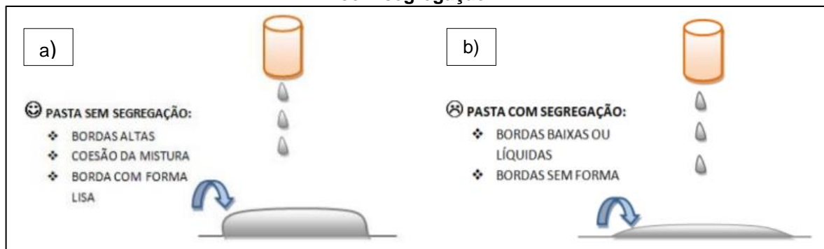
Figura 5 - Determinação visual da segregação na pasta. a) Pasta sem segregação; b) Pasta com segregação.
