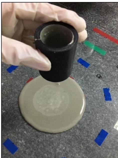
Figura 59 - Ensaio de espalhamento da argamassa com resíduo de cerâmica branca com diâmetro médio de 125 mm
