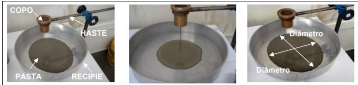
Figura 4 – Ensaio com Cilindro Espanhol. a) Componentes do Equipamento; b) Argamassa passando no orifício do copo; c) Determinação do espalhamento através da média dos dois diâmetros.
