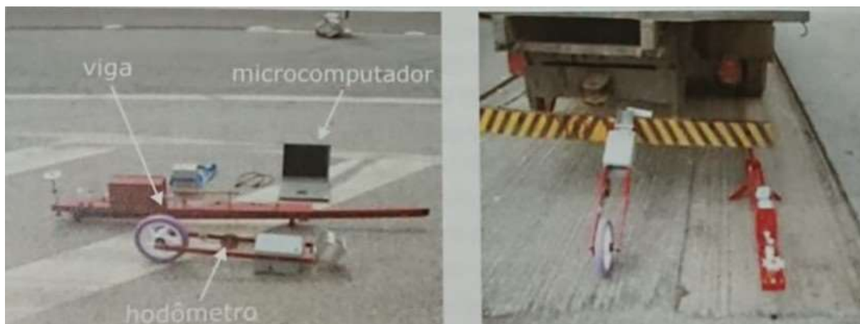
Figura 6 – Viga Benkelman automatizada desenvolvida pela COPPE/UFRJ
