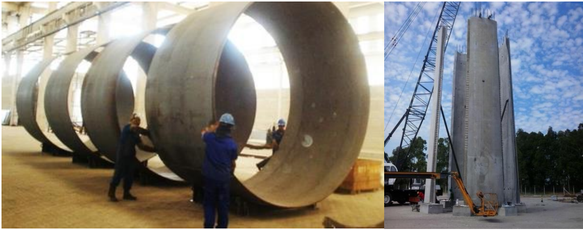
Figura 5: Tipos de Torres a) Aço; b) Concreto.
