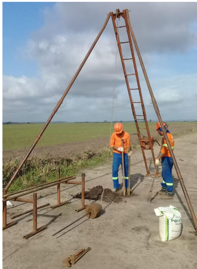
Figura 16: Execução do ensaio SPT
