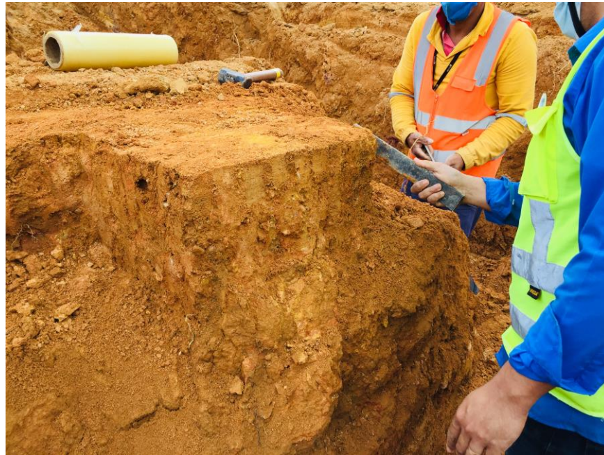
Figura 42: Escavação manual para retirada da amostra
