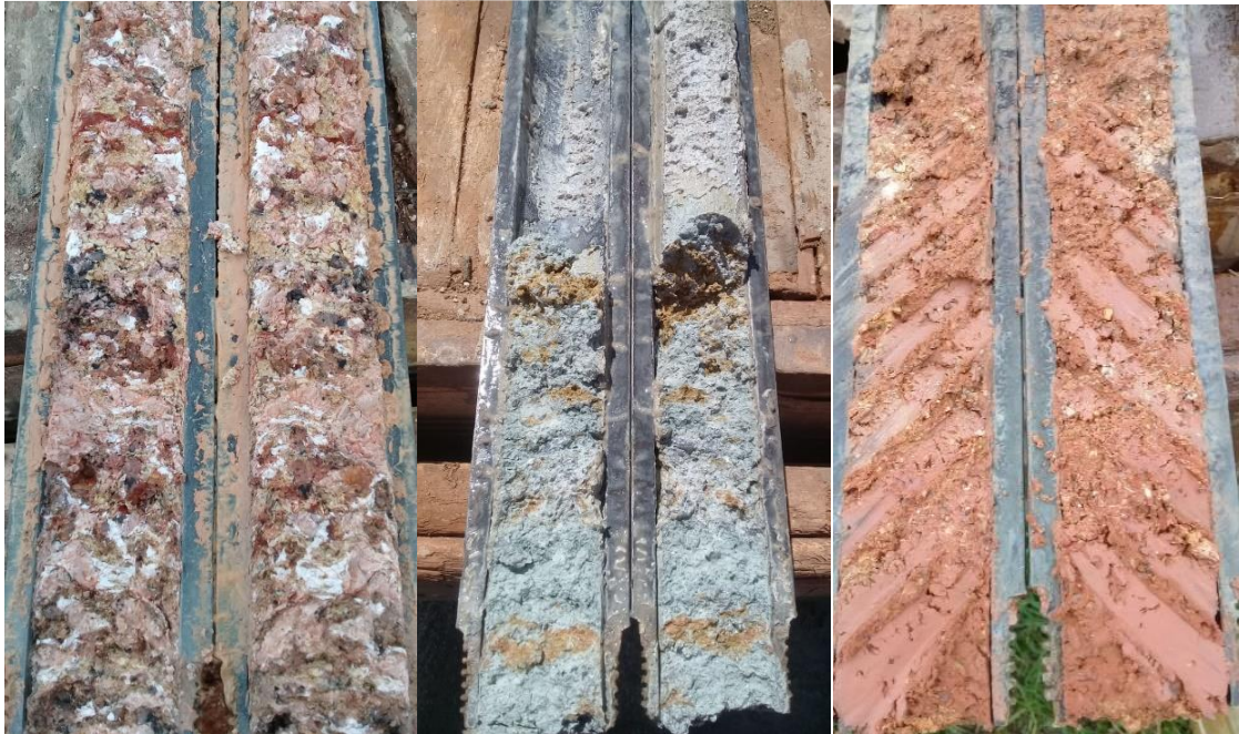
Figura 17: Amostras coletadas a cada metro do ensaio SPT
