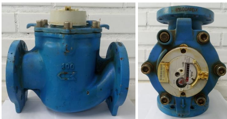
Figura 11 - Hidrômetro Velocimétrico Woltmann
