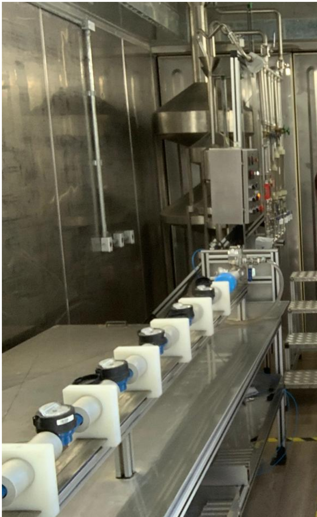
Figura 30 - Bancada volumétrica para ensaios em hidrômetros – registro de ensaios
