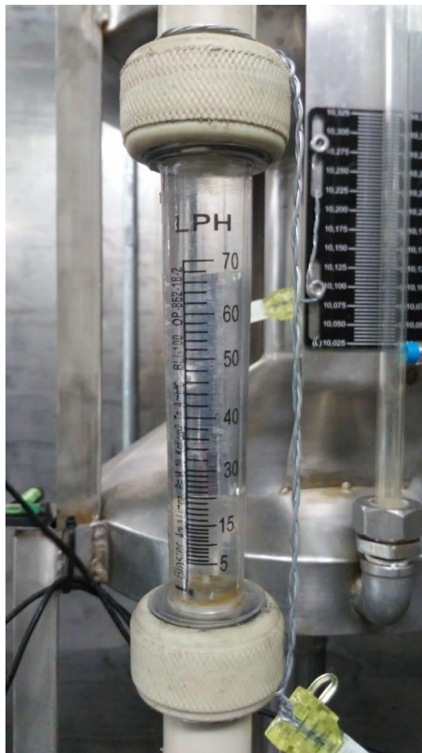
Figura 20 - Rotômetro utilizado para ajuste de vazão do ensaio. Ao fundo, visualiza-se tanque de referência e respectivo vaso comunicante em vidro para visualização do nível e régua para leitura
