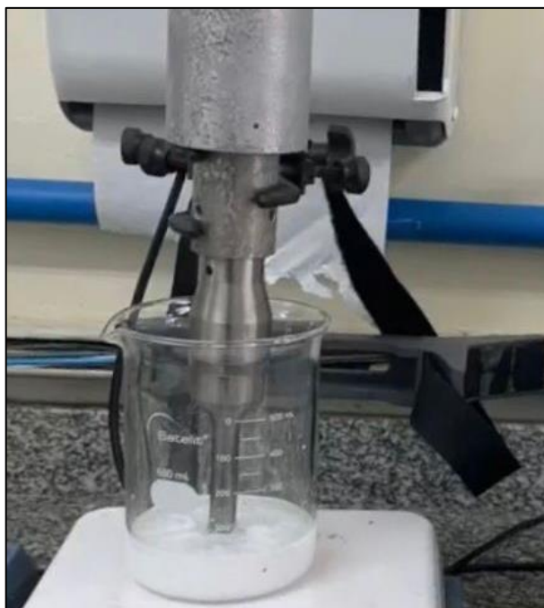
Figura 18 - Procedimento de dispersão da nanocelulose através do sonicador.
