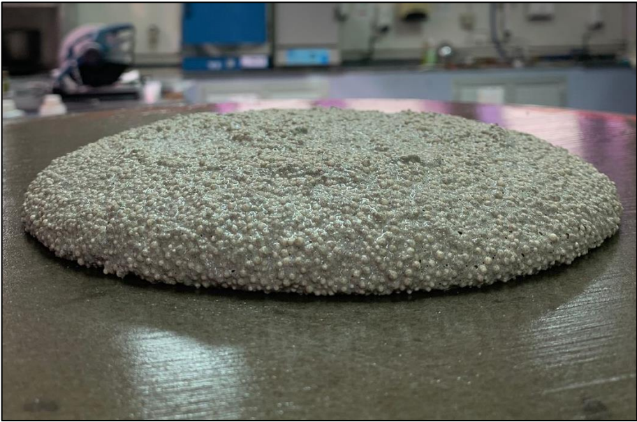
Figura 35 - Argamassa AN003 após o ensaio de consistência.
