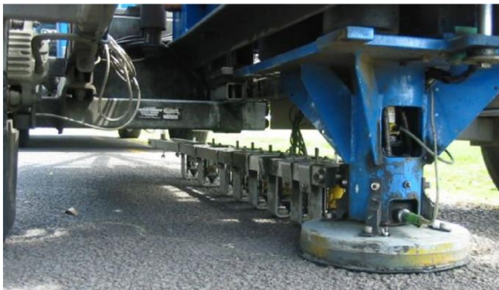
Figura 16 - Equipamento FWD - carga circular e sensores.
