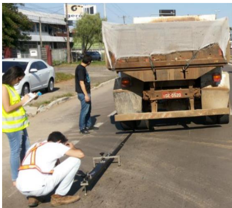
Figura 10 - Ensaio VB em campo.
