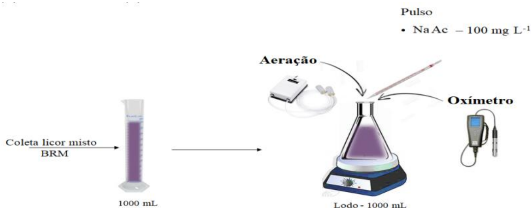
Figura 15 - Aparato experimental e metodologia utilizada para obter as TCOs
