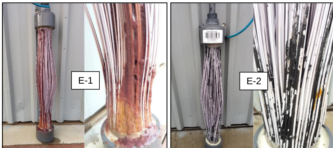
Figura 39 - Aspecto visual do módulo de membrana ao final da E-1 e E-2
