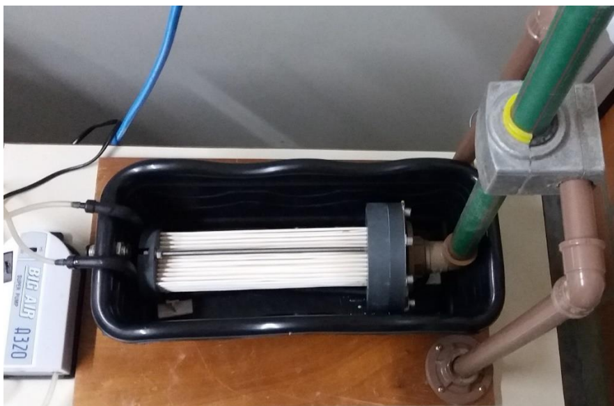
Figura 18 - Aparato experimental utilizado para determinação das resistências à filtração
