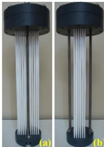
Figura 17 - Vista (a) frontal e (b) lateral do módulo de membranas de microfiltração Polymem
