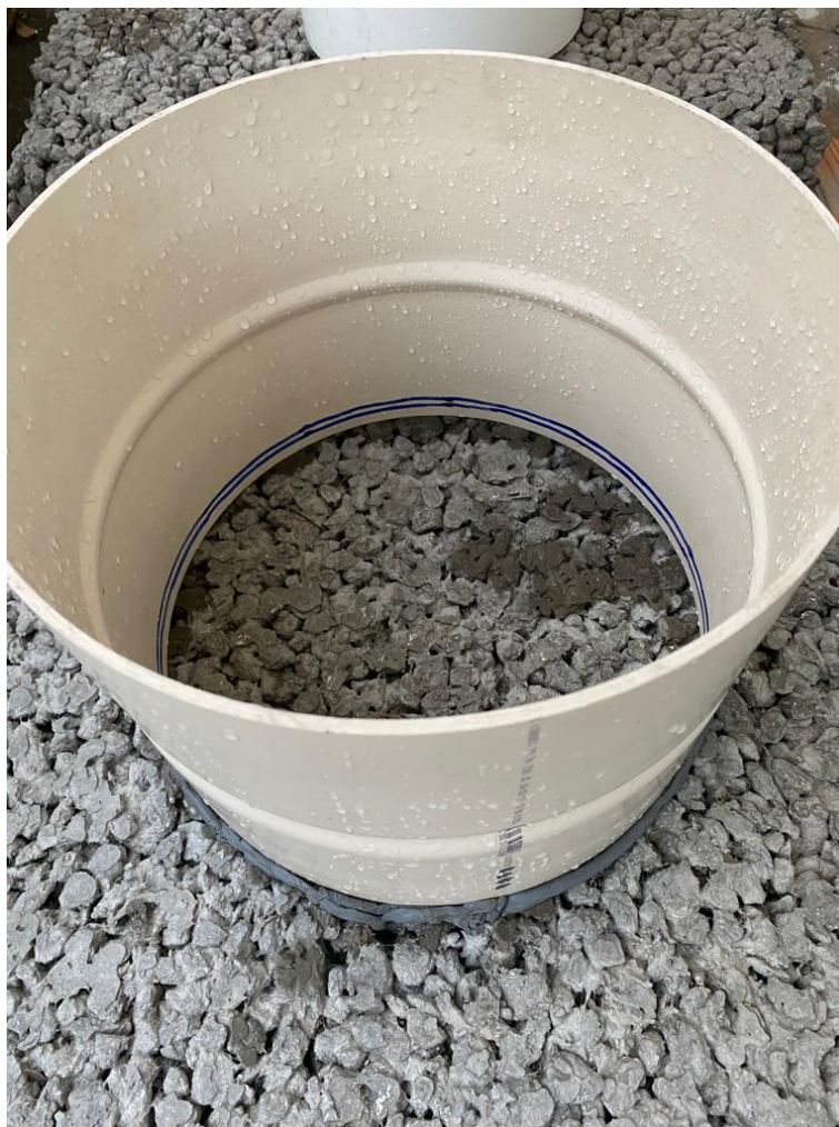
Figura 15 – Ensaio de permeabilidade
