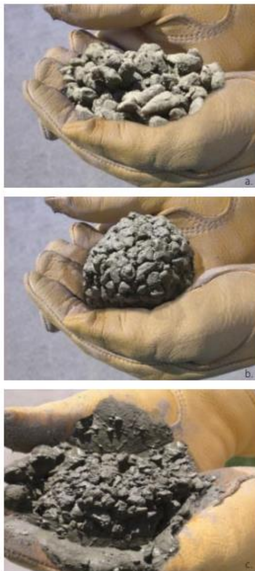
(a) pouca água (b) quantidade adequada de água (c) muita água.
