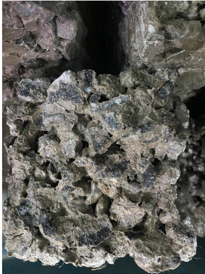
Figura 13 – Seção do corpo de prova após rompimento
