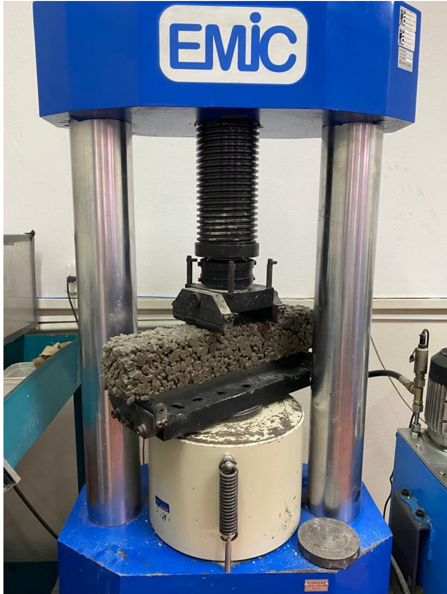
Figura 12 – Ensaio resistência à tração na flexão
