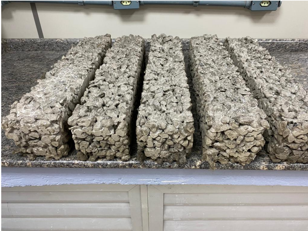
Figura 11 – Corpos de prova resistência à tração na flexão
