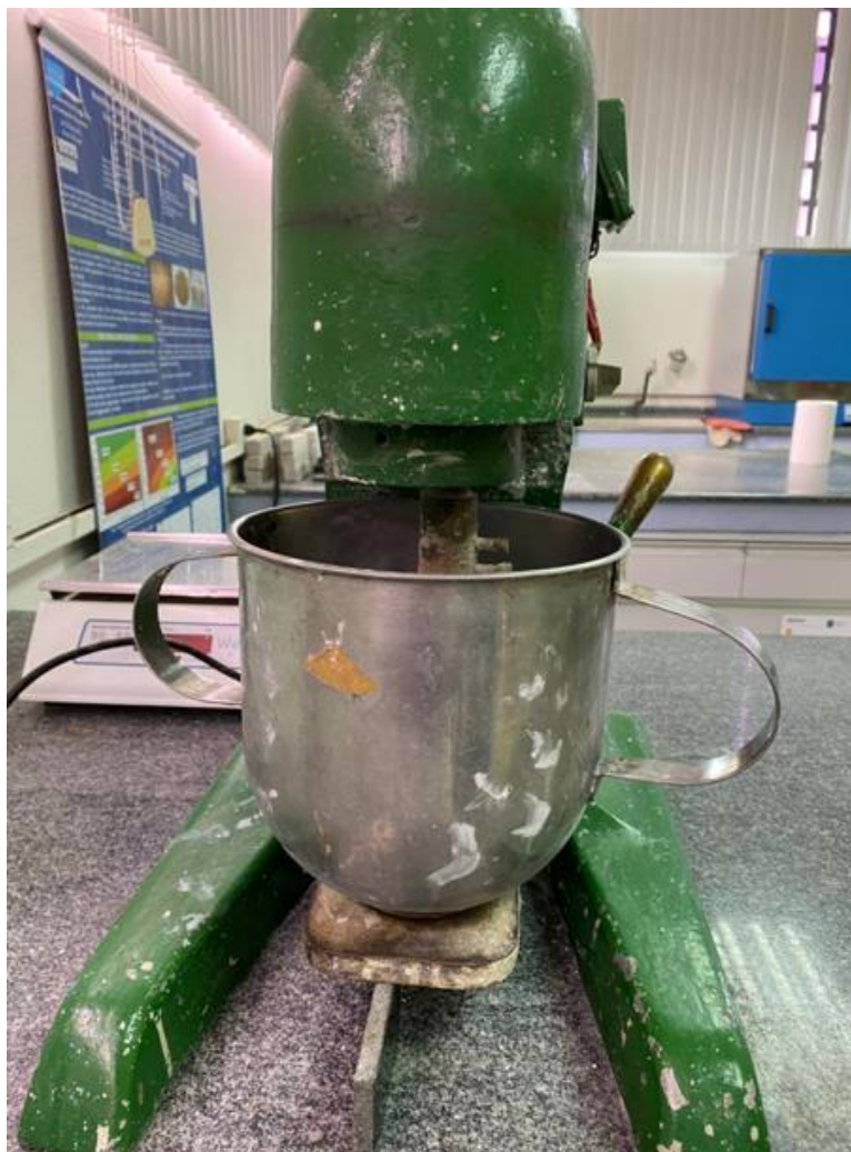
Figura 16 – Misturador para pasta de cimento
