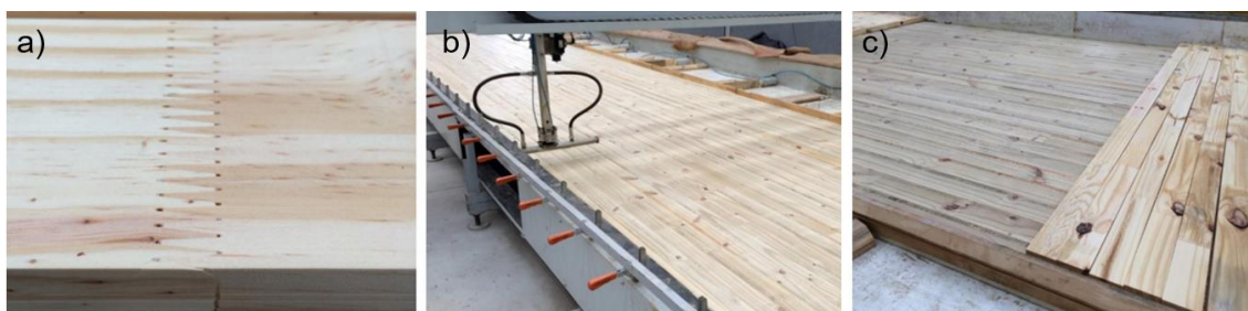
Figura 6. Ligação finger-joint (a); aplicação do adesivo estrutural (b); posicionamento das lamelas em sentido perpendiculares entre si (c).
