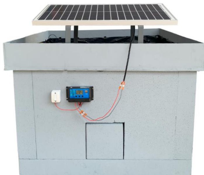
Figura 6. Edificação, estrutura do telhado verde impermeabilizada, módulo fotovoltaico e suas instalações elétricas.
