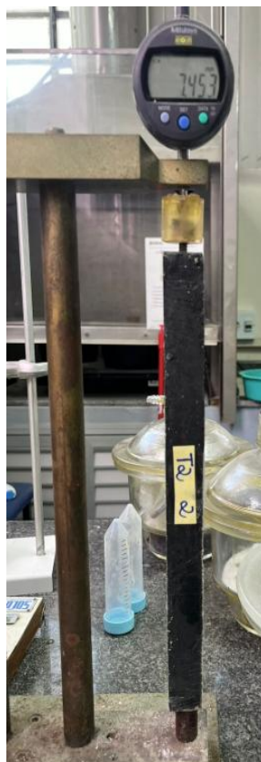
Figura 25 - Equipamento para medição retração linear
