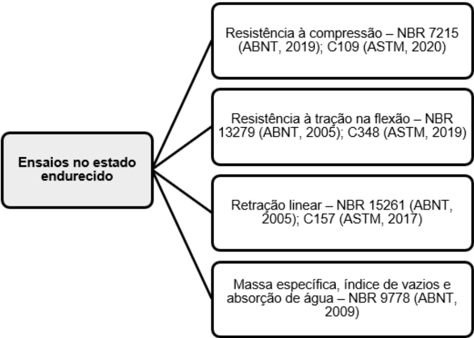
Figura 24 - Fluxograma de ensaios no estado endurecido
