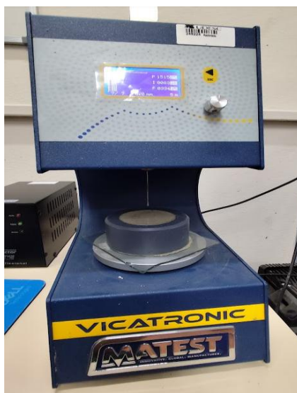
Figura 23 - Ensaio do tempo de pega automático com aparelho de Vicat
