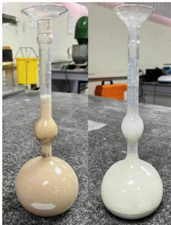
Figura 20 - Frasco Volumétrico com amostras de MC e Escória
