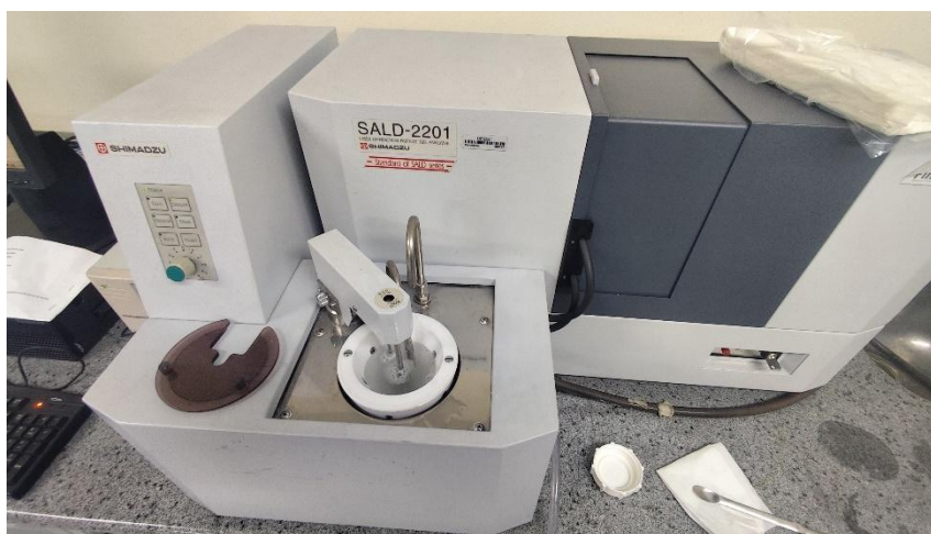
Figura 21 - Equipamento Analisador de tamanho de partículas
