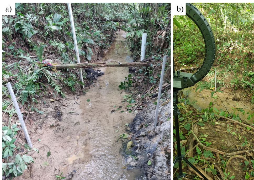
Figura 51 – a) Proposição de quatro pontos instalados para o experimento com LSPIV; b) Utilização de tripé para filmagem.
