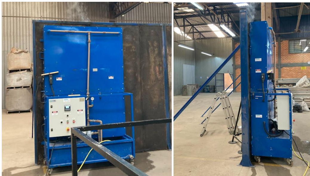
Figura 58 – Execução do ensaio de calor e choque térmico.
