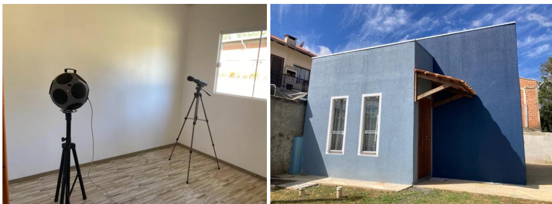
Figura 16 – Equipamentos utilizados no ensaio acústico in loco e edificação.
