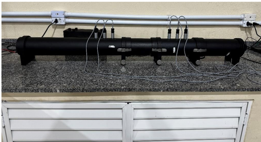
Figura 17 – Tubo de impedância utilizado.
