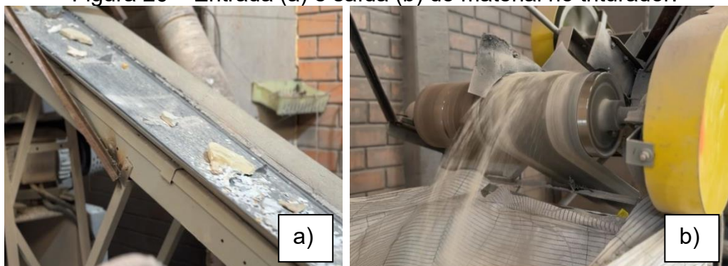
Figura 26 – Entrada (a) e saída (b) do material no triturador.
