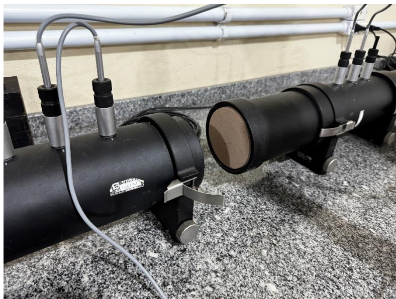
Figura 54 – Corpo de prova 1 com 100 mm de diâmetro posicionado.
