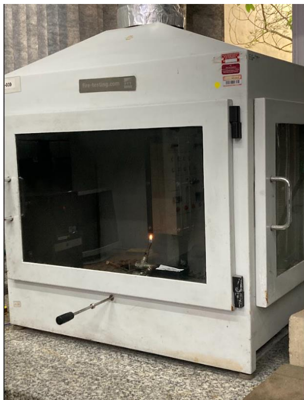
Figura 23 – Câmara de ensaio com queimador ligado.
