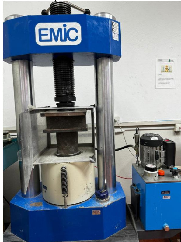
Figura 36 – Execução do ensaio de resistência à compressão.
