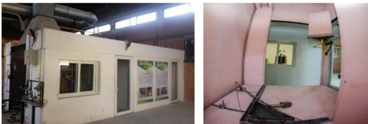
Figura 21 – Equipamento utilizado para ensaio de reação ao fogo.
