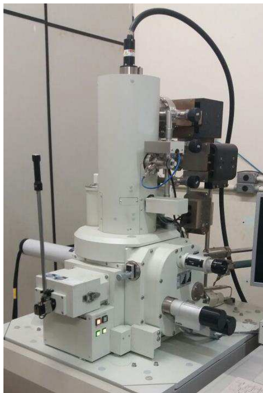
Figura 24 – Microscópio Eletrônico de Varredura
