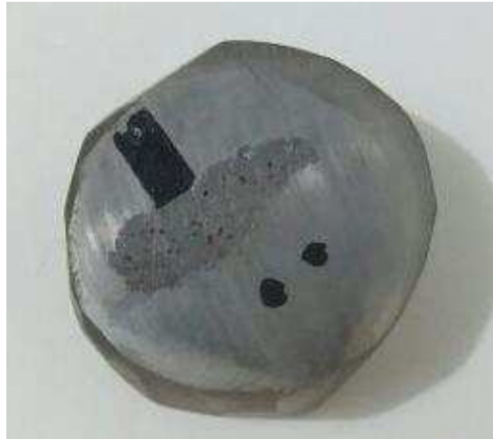
Figura 26 – Amostra de microscopia após o recobrimento
