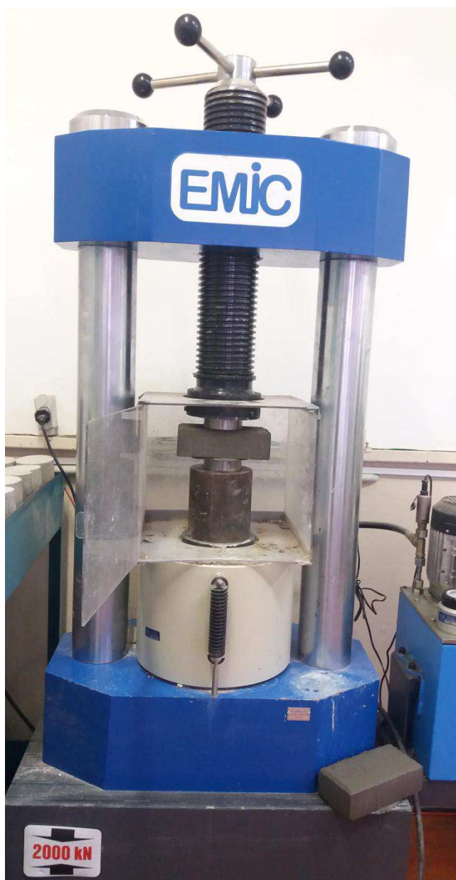
Figura 23 – Máquina utilizada no ensaio de resistência à compressão
