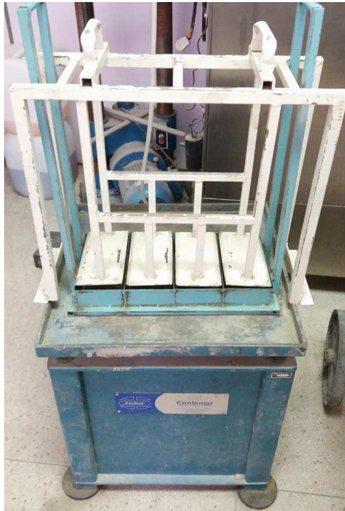
Figura 17 – Vibroprensa manual com baixa energia de compactação
