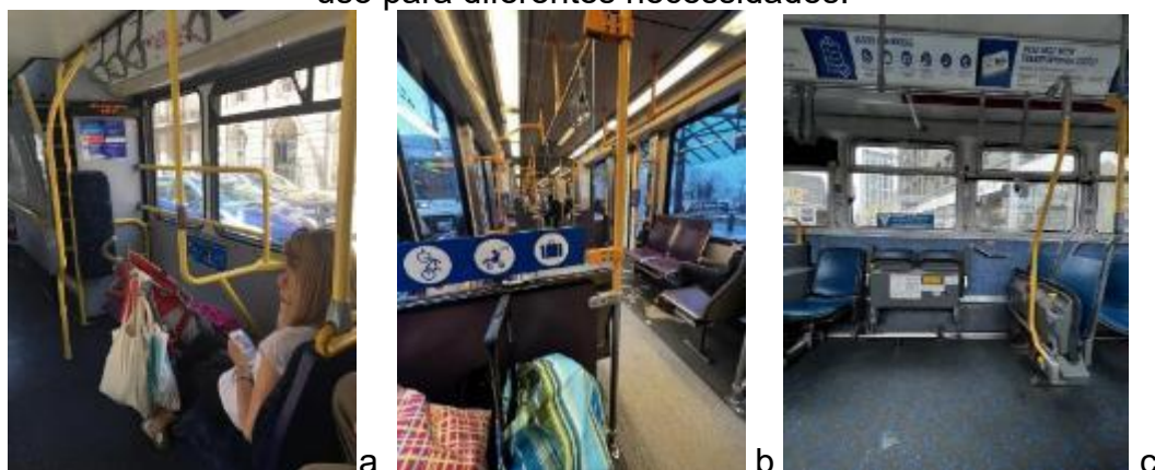
Figura 45 – Layout interno com área para acomodação de carrinhos de bebê, bagagens, andadores, bicicletas, cães guia etc. Bancos retráteis para flexibilidade do uso para diferentes necessidades.
