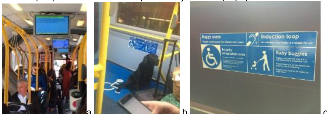
Figura 46 – a) e b) Informação ao usuário de forma visual e sonora; c) Identificação por placa do sistema Loop de Indução em espaço preferencial.
