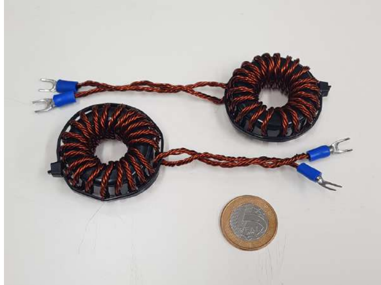
Figura 62 – Indutores intercalados ( L_{1,2} ) confeccionados para o protótipo do inversor.
