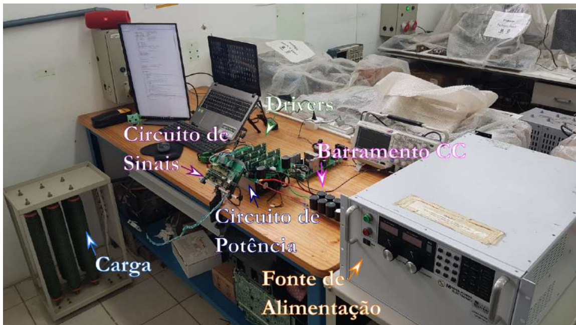
Figura 65 – Protótipo de 1,5 kW do inversor ANPC-5L-MSSC montado em laboratório.
