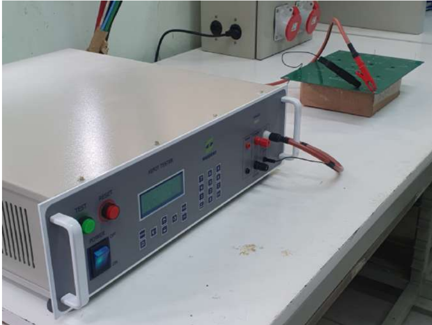
Figura 72 – Ensaio de HIPOT com setup montado em bancada.
