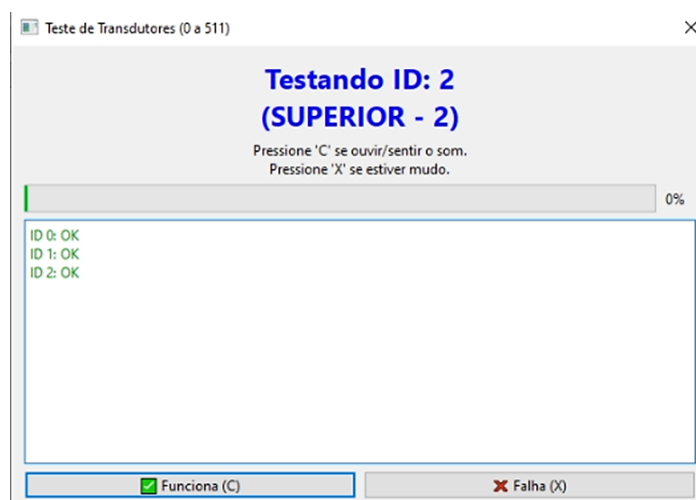
Figura 14 – Definição de quais transdutores estão operacionais ou defeituosos
