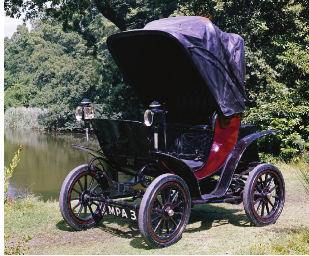
Figura 2 – Carruagem elétrica produzida por City and Suburban Electric Carriage Company em Londres, Reino Unido.
