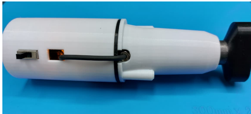
Figura 22 – Fotografia do dispositivo de bioimpedância após montagem mecânica completa.
