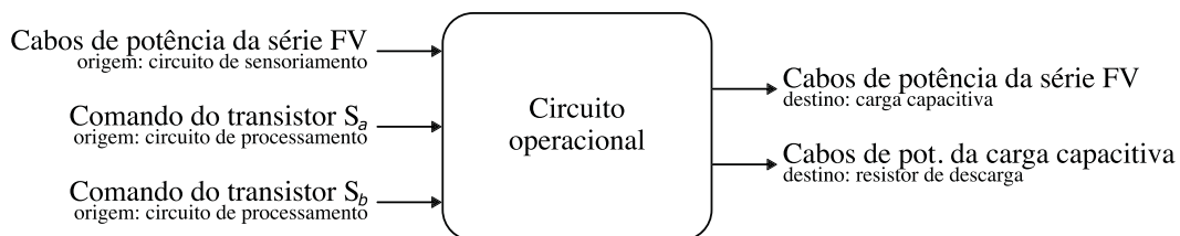
Figura 31 – Diagrama de entradas e saídas do circuito operacional.
