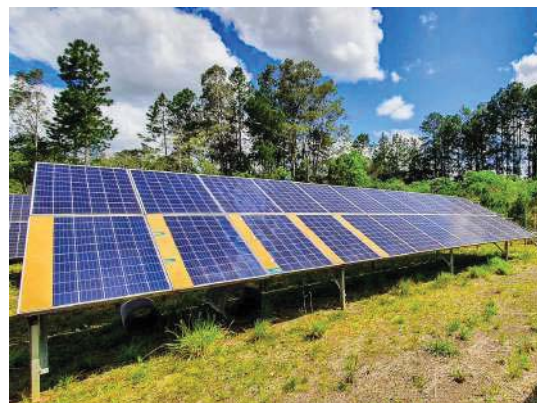
(d) Série FV limpa com uma coluna de células sombreada em cinco módulos.
