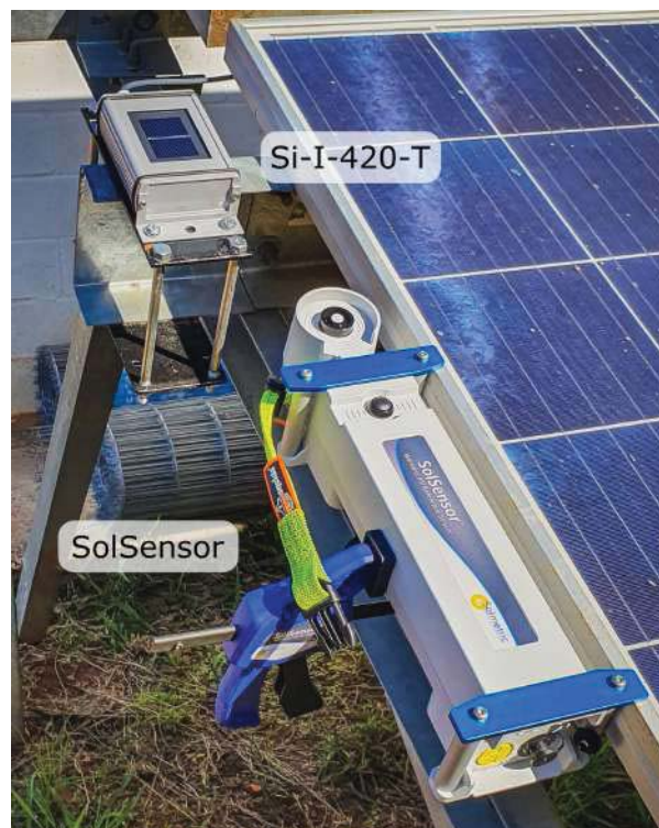
Figura 39 – Ensaio para calibração e ajuste do circuito para medição da irradiância no plano inclinado.
