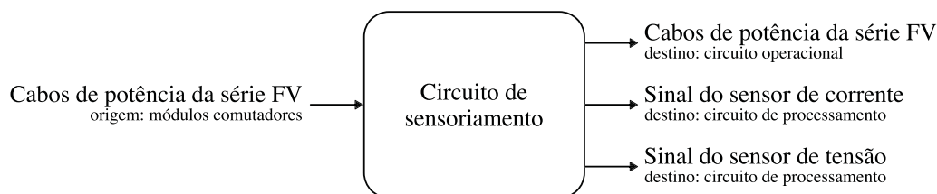
Figura 29 – Diagrama de entradas e saídas do circuito de sensoriamento.
