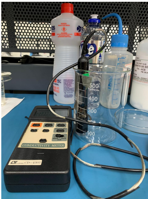
Figura 25 – Bancada experimental para teste de condutividade. Fonte: autora (2022).
