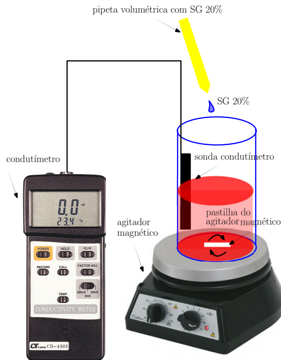
Figura 24 – Representação da bancada experimental para teste de condutividade. Fonte: autora (2022).
