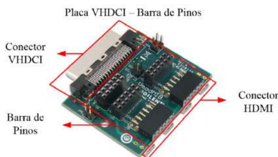
Figura 110 - Modelo da placa que altera a conexão de VHDCI para barra de pinos.
