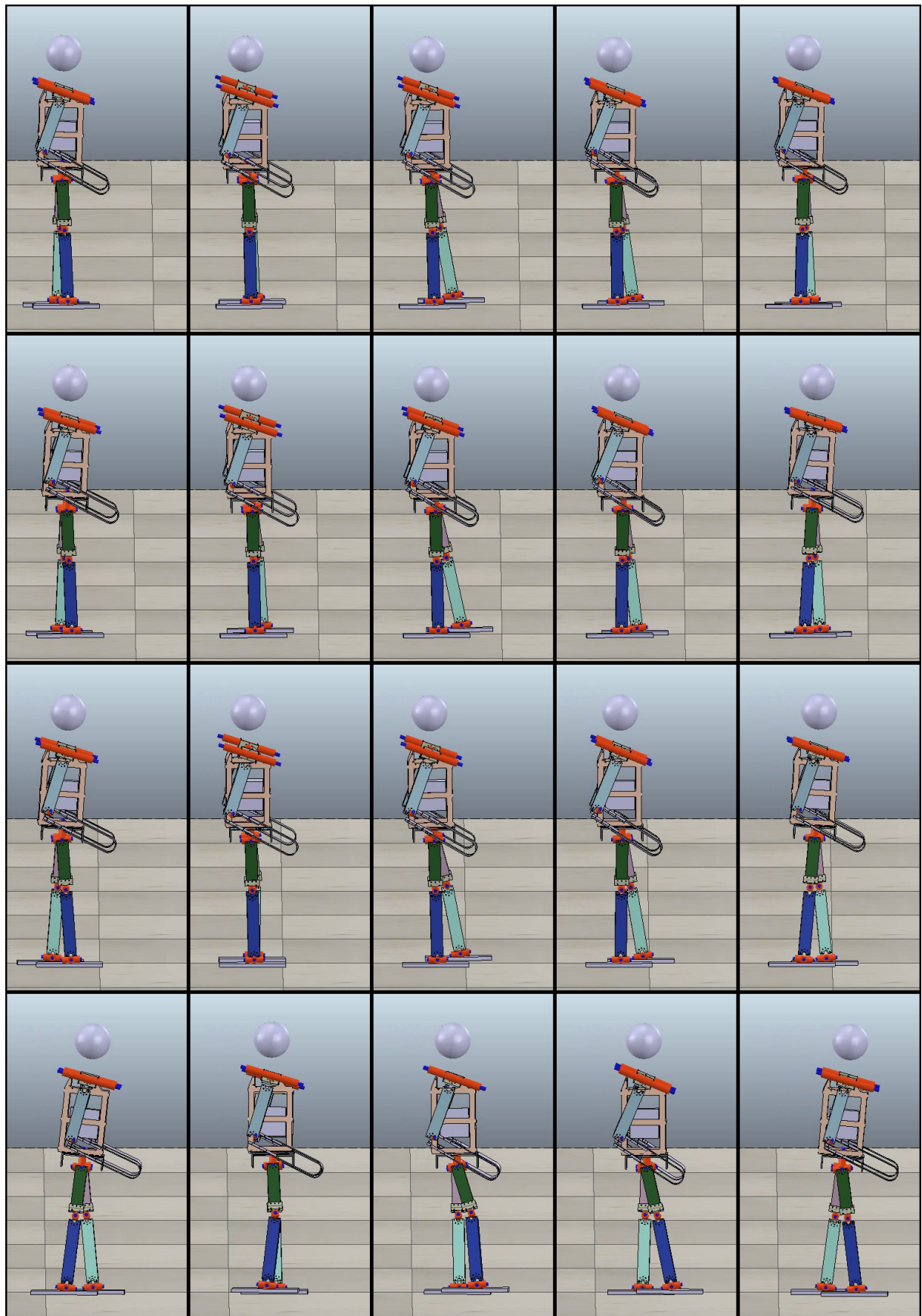
Figura 6.8 – Screenshots da simulação do RoboFEI com aumento progressivo do tamanho do passo: visão sagital.
