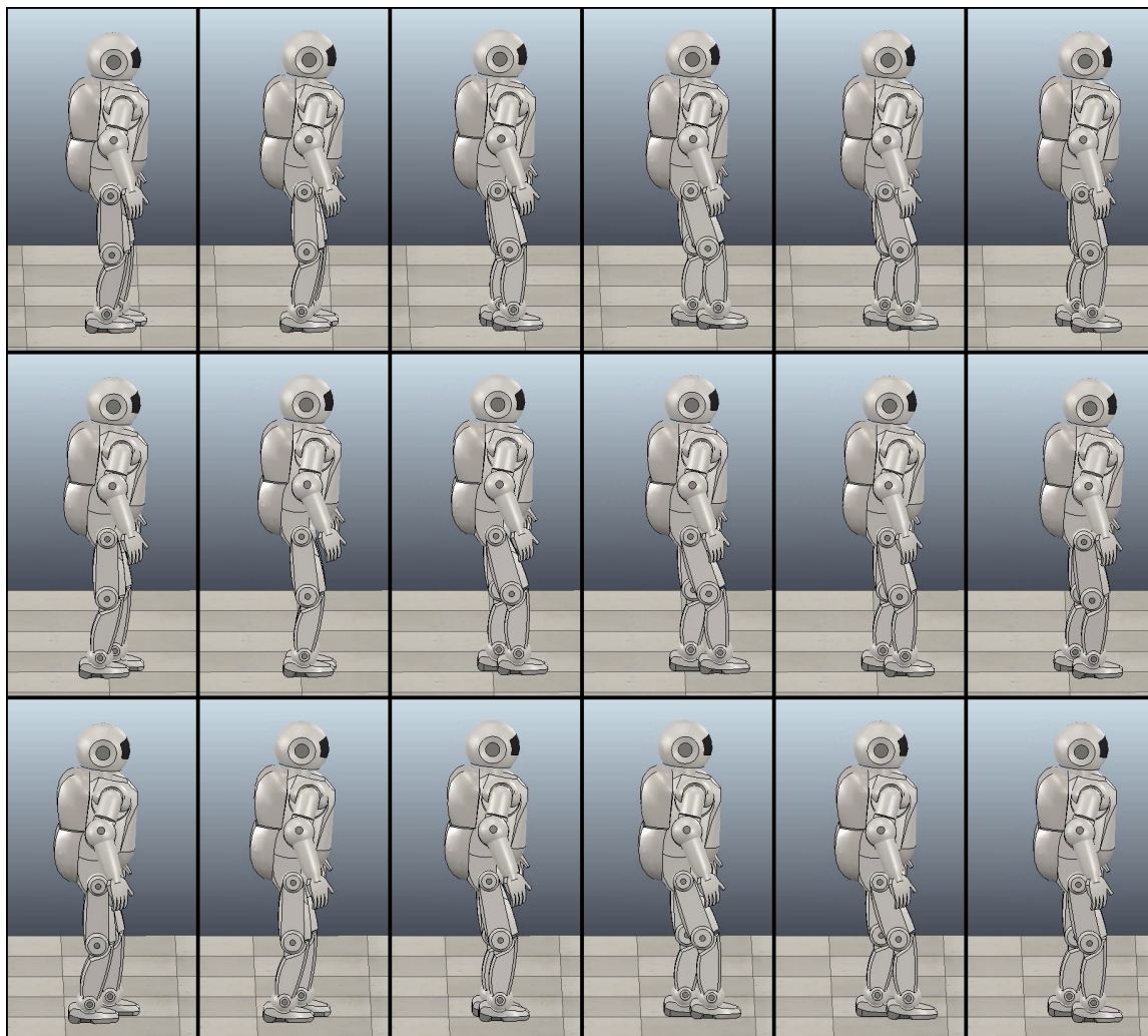
Figura 6.26 – ASTI: Screenshots da simulação com aumento progressivo do tamanho do passo: visão sagital.
