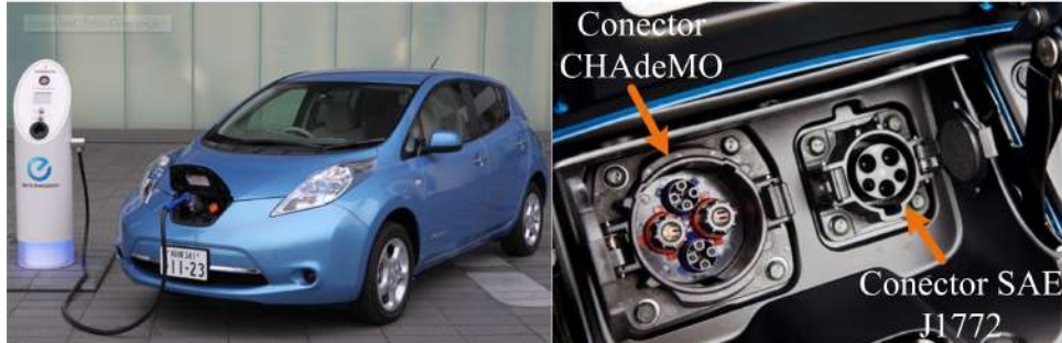
Figura 3 – Automóvel Nissan Leaf com mais de um tipo de conector para recarga.
