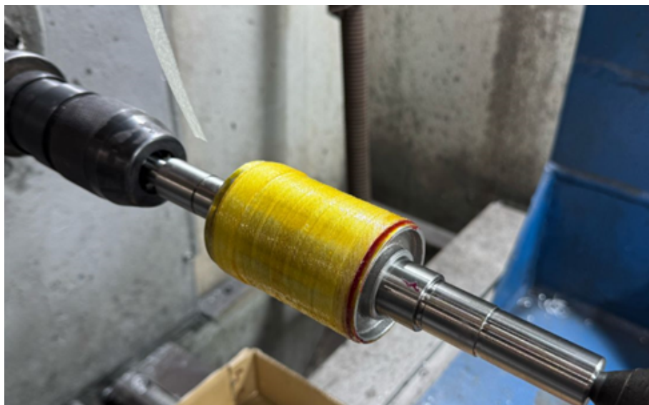
Figura 17 – Rotor após aplicação da bandagem. Fonte: Produção do autor.
