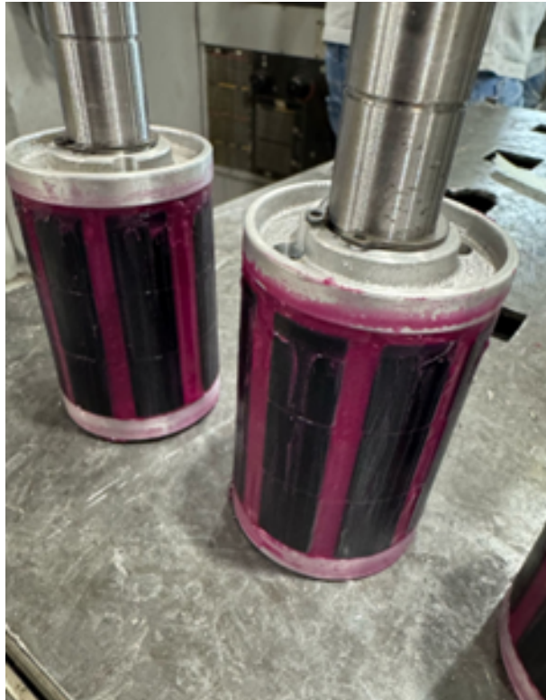
Figura 16 – Detalhe da cola aplicada para segurar os ímãs, em roxo. Fonte: Produção do autor.
