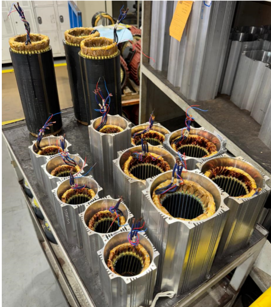
Figura 21 – Exemplo de estator de servomotores com rotor de ímãs Fonte: Produção do autor.
