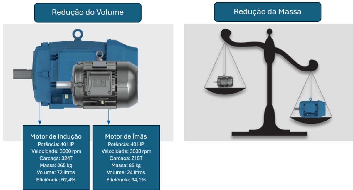
Figura 8 – Comparação entre um motor de indução e ímãs
