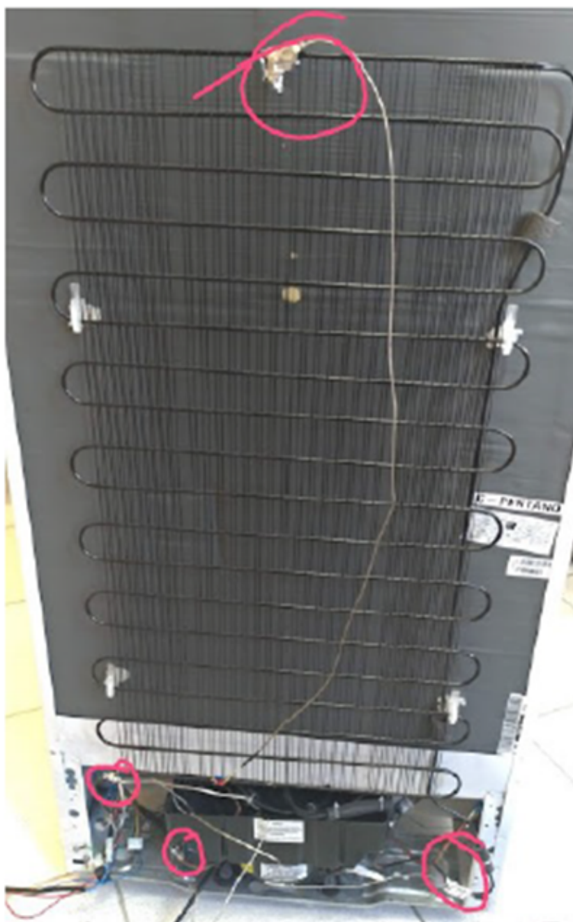
Figura 55 – Posicionamento dos termopares no produto indicados pelos círculos vermelhos. Fonte: AUTOR (2021).
