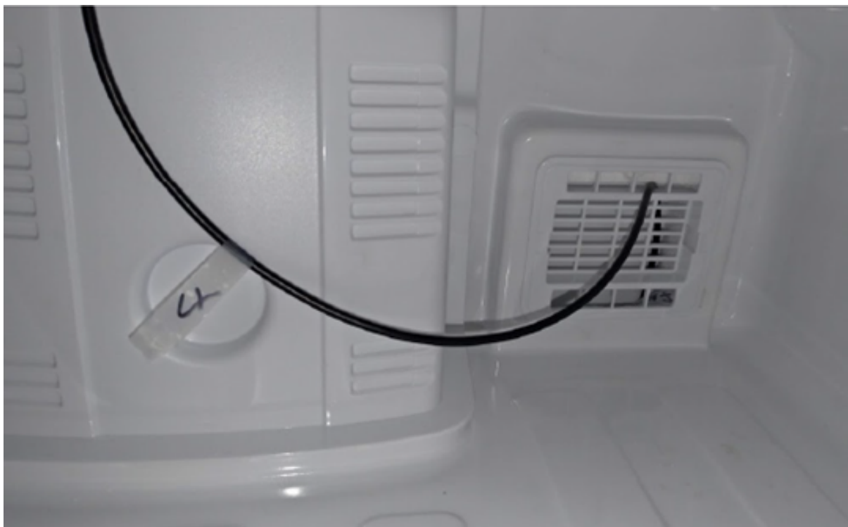
Figura 53 – Medição de temperatura no retorno de ar "quente" no refrigerador, atrás da gaveta de legumes. Fonte: AUTOR (2021).
