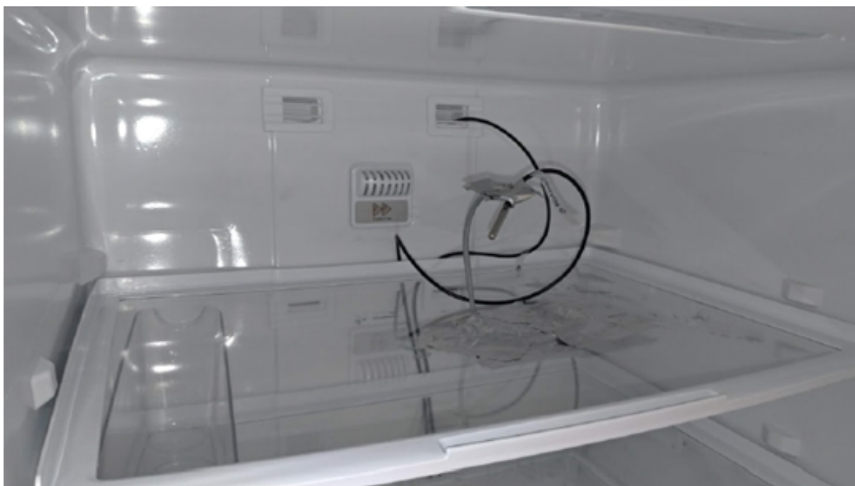
Figura 52 – Medições de temperatura no refrigerador, saída de ar frio e nos centros geométricos (suspensos) dos compartimentos. Fonte: AUTOR (2021).
