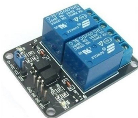
Figura 56 – Módulo de relés para controle de ventilador e resistência de degelo. Fonte: AUTOR (2019).
