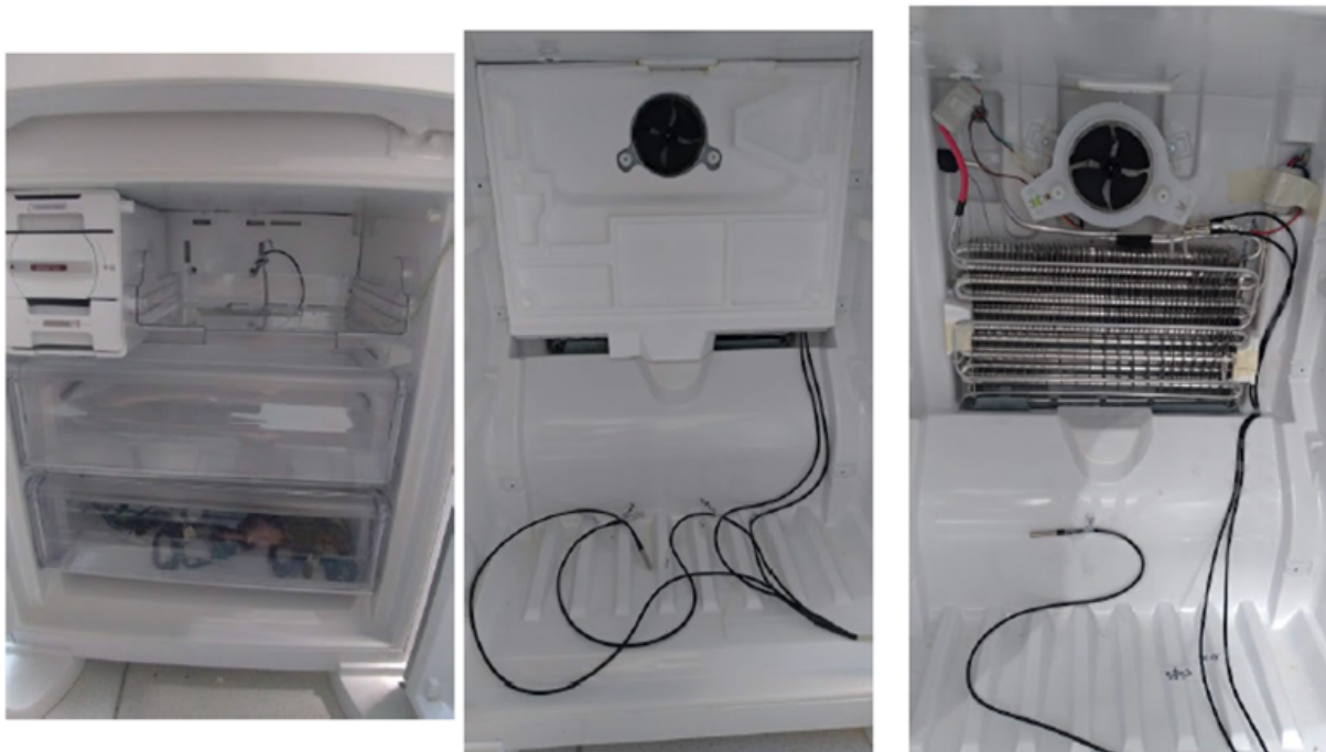
Figura 51 – Medições de temperaturas dentro do congelador. À esquerda, freezer com gavetas montadas, ao centro, sem gavetas e com capa plástica e à direita, a evaporadora exposta e insuflador com medição de temperatura. Fonte: AUTOR (2021).
