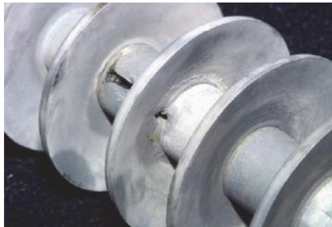
Figura 2 - Perfuração em isolador de compósito.
