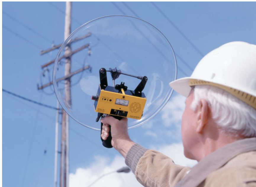
Figura 6 - Inspeção do sistema de distribuição por meio do detector de ultrassom.
