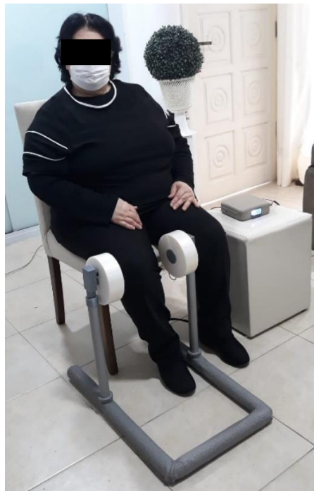
Figura 34 – Equipamento PEMF desenvolvido posicionado ao redor do joelho
