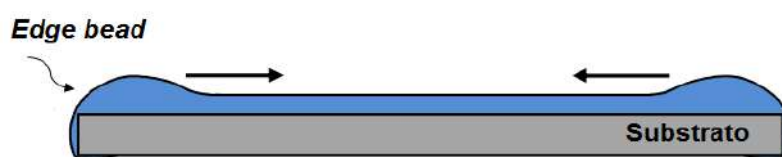
Figura 7 – Formação de edge bead sobre o substrato.
