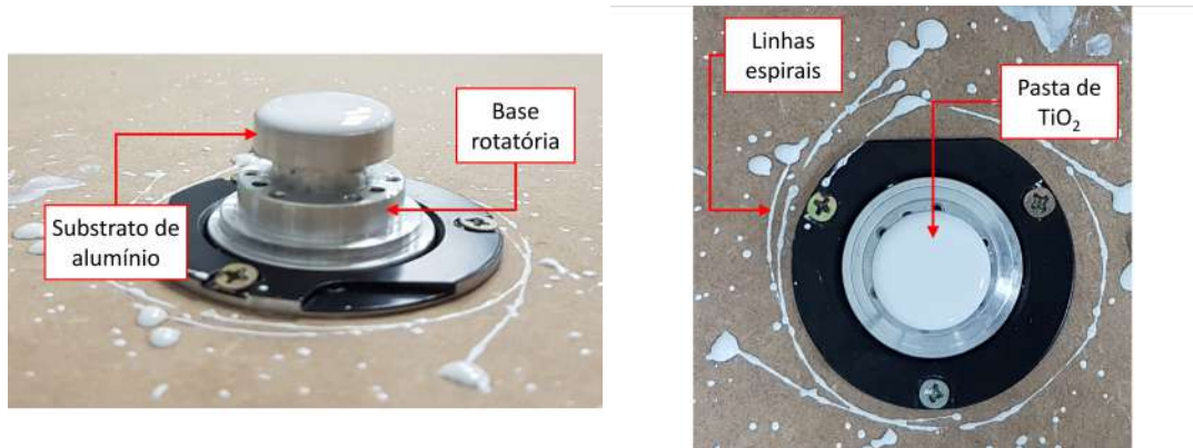
Figura 12 – Características da pasta de \text{TiO}_2 durante as deposições.
