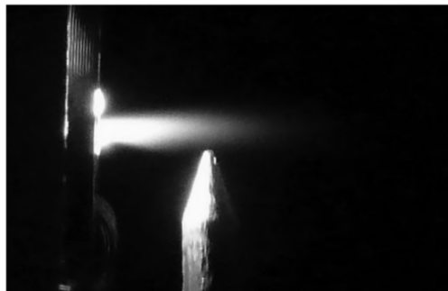
Figura 31 – A pluma de plasma de ar não sofre alterações em sua trajetória devido à presença de um eletrodo aterrado em sua proximidade.
