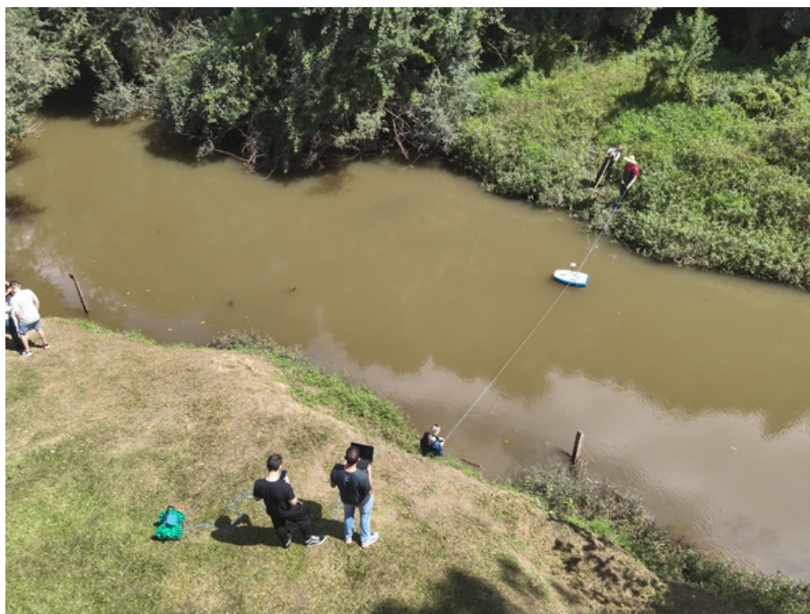
Figura 3 – Medição de vazão na seção de interesse utilizando o ADCP.
