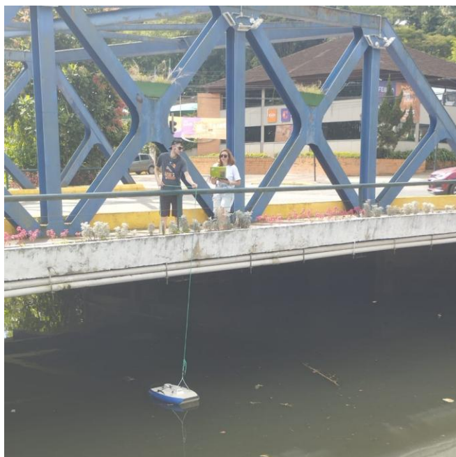
Figura 3: Procedimento de medição de vazão com o ADCP.
