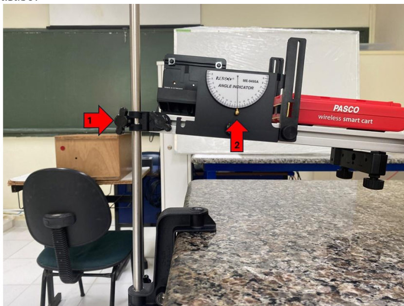
Figura 1: Montagem e configuração. 1. Parafuso de fixação, 2. Indicador de ângulo.
