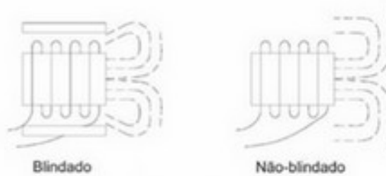
FIGURA 3.7 Blindagem dos sensores indutivos.
