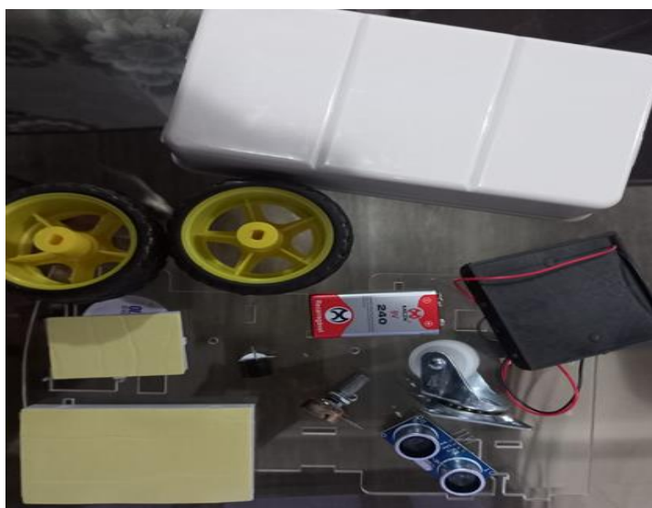
Figura 2. Kit explorador uno, composto por uma base de acrílico, rodas, uma placa de circuito interno, motor elétrico, pilhas, baterias e componentes eletrônicos e mecânicos.
