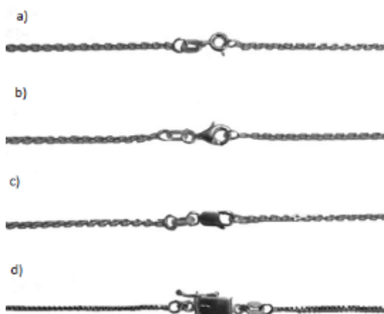
Figura 9 – Sistemas de fecho utilizados no experimento: a) fecho argola; b) lagosta; c) mosquetão; d) caixa
