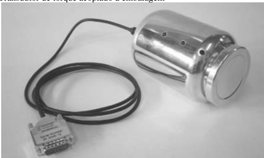
Figura 5 – Transdutor de torque acoplado à embalagem
