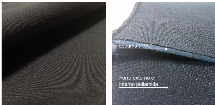
Figura 8 - detalhe do material politex utilizado para confecção da órtese.
