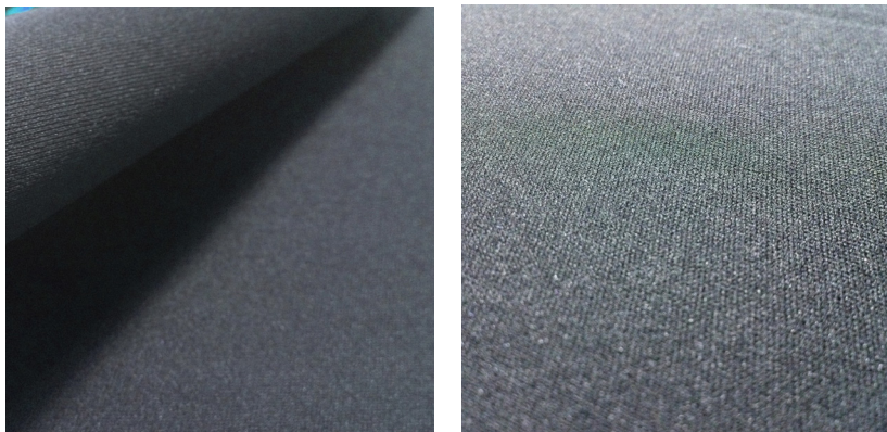
Figura 6 - detalhe do tecido Emanar® 350g aplicado no forro da órtese
