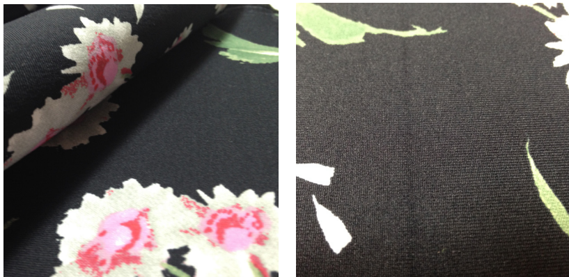
Figura 5 - detalhe do tecido Emanar® 270g aplicado no forro da órtese
