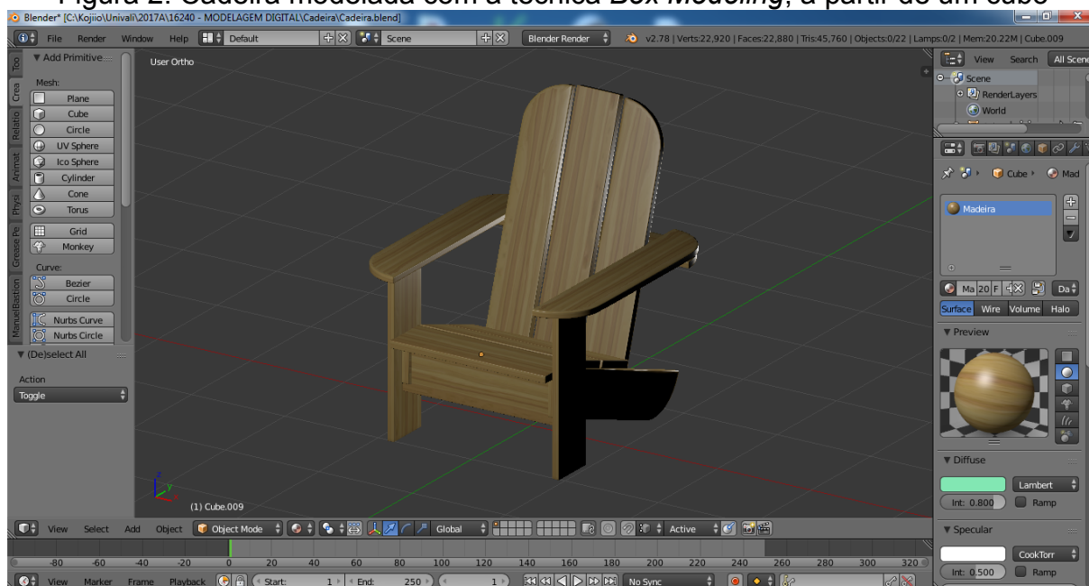
Figura 2: Cadeira modelada com a técnica Box Modeling , a partir de um cubo
