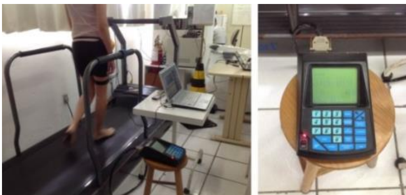
Figura 15 - Esteira Ergométrica multiprogramável e display de controle do sistema – Laboratório de Pesquisas em Desempenho Humano (Lapedh)/ UDESC, onde os testes foram executados.
