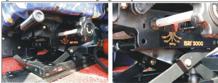
Figura 16: Assento Motorista 3 regulagem do peso e sistema de molas
