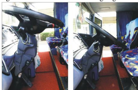
Figura 17: Volante Motorista 3 regulagem da altura
