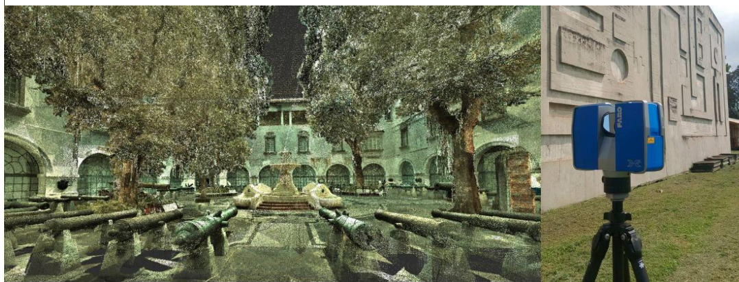
Figura 4. Laser scanner que realiza uma varredura tridimensional em edificações de interesse cultural.
