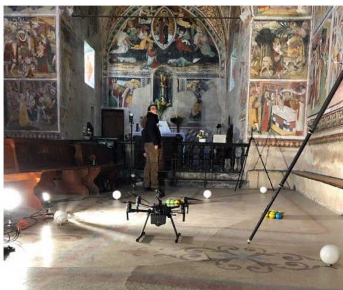
Figura 1. Levantamento da capela de Notre Dame des Fontaines em La Brigue com ortofotogrametria e auxílio de drone.
