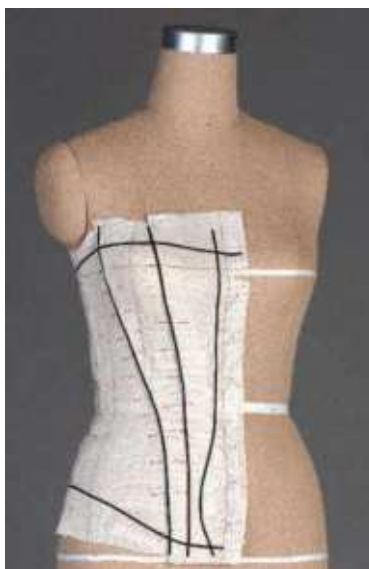
Figura 40 – Criação do modelo por meio da moulage
