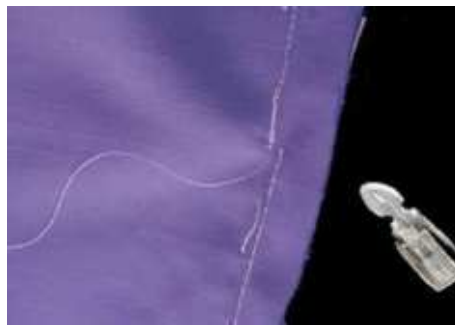
Figura 76 – Fechamento da parte de baixo do zíper
