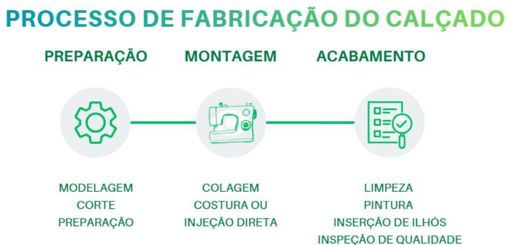
Figura 12 — Etapas do processo de fabricação do calçado
