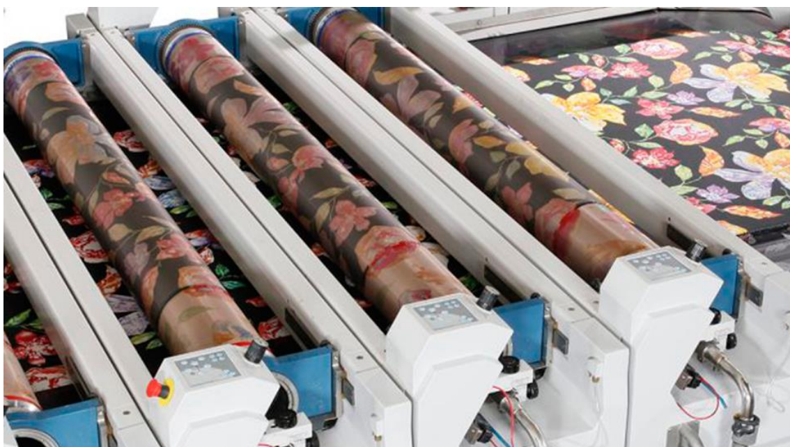
Figura 44 – Estamparia por cilindros
