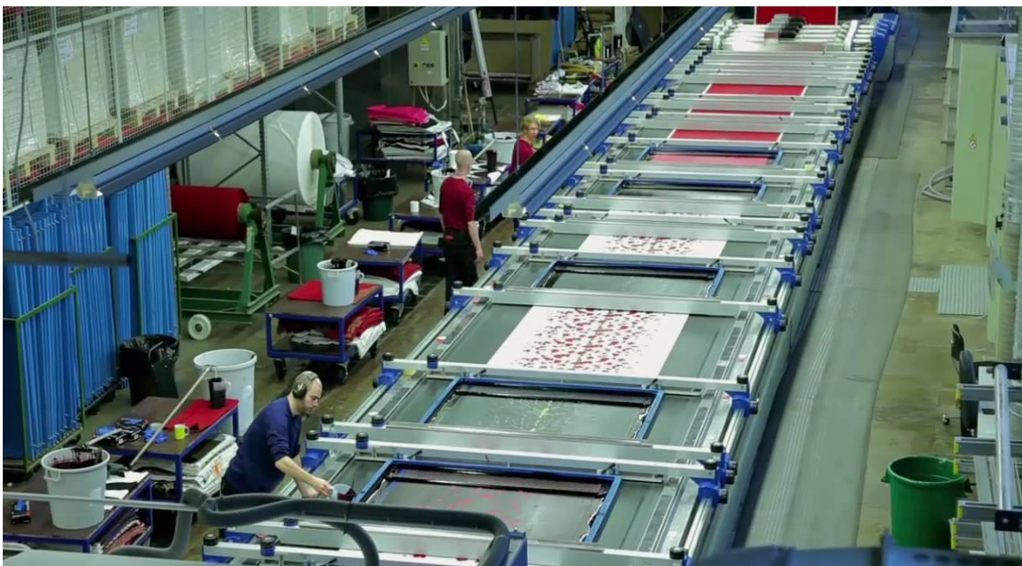
Figura 43 – Estamparia a quadro automático
