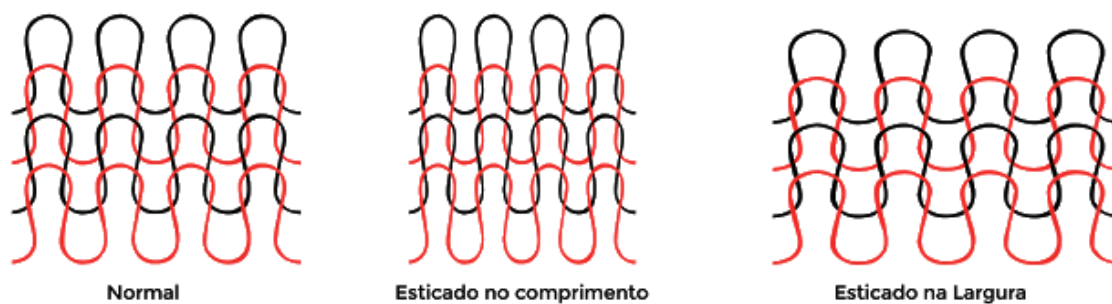
Figura 3 – Entrelaçamento do tecido de malha
