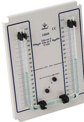
**Painel tubo em U:** realização de experimentos de física, hidrostática, sobre vasos comunicantes peso específico, etc.
