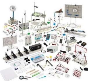
**Conjunto para experiência de laboratório:** Roldanas, empuxo, lei de hooke, pêndulo e lançamento de projéteis.
