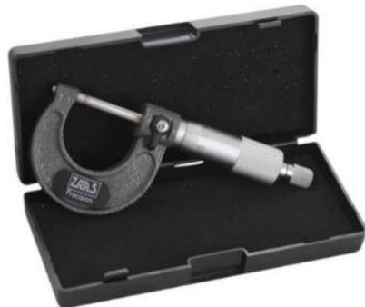
**Micrometro:** Para medir dimensões externas e internas.
