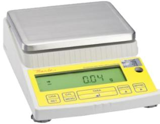
**Balança:** São equipamentos específicos para medições precisas da massa de um corpo em laboratório para segmentos em que análises, formulações e experimentos em geral requerem total precisão.
