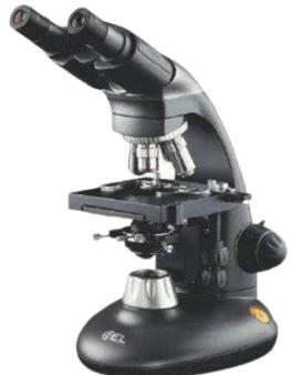
**Microscópio:** Utilizado para visualizar minúsculas estruturas, o microscópio é um equipamento essencial para qualquer laboratório.
