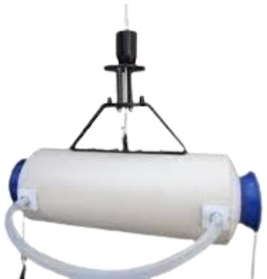
**Garrafa de Van Dorn:** As Garrafas do tipo Van Dorn são utilizadas para a coleta de água em lagos e córregos próximas ao fundo. Foram projetadas para atender todas as necessidades de coleta horizontal de amostras de água para medição de parâmetros ambientais.
