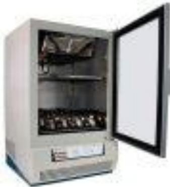
**Estufa:** Estufa de secagem para laboratório é conhecida como um aparelho elétrico utilizado para secagem de substâncias sólida, evaporação lenta de líquido, armazenagem de substâncias líquidas com temperaturas baixas, secagem de vidrarias.
