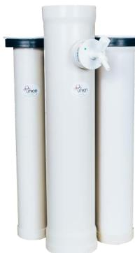
**Deionizador uso em Laboratório:** A função básica de um deionizador para laboratório é retirar todo e qualquer vestígio de cátions, cloro, ânions, metais pesados, amônia, nitratos e vários outros componentes químicos que possam ser nocivos à água, que possam contaminar.
