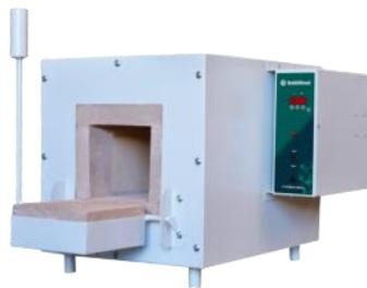
**Forno para Laboratório:** Forno Mufla ou Forno de Mufla é um equipamento de extrema importância em um laboratório. Basicamente, um forno mufla é bastante similar a uma estufa, e é utilizado, principalmente, em laboratórios de química, quando da necessidade de temperaturas muito elevadas na calcinação de substâncias.
