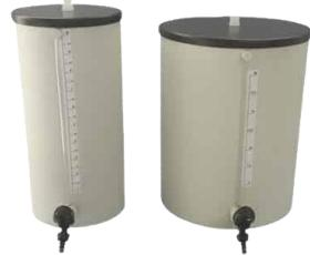
**Barrilete:** é utilizado em todos os tipos de laboratórios para o armazenamento de água pura e soluções preparadas, oferecendo segurança e evitando a contaminação.
