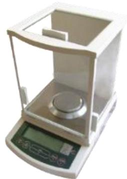
**Balança:** São equipamentos específicos para medições precisas da massa de um corpo em laboratório para segmentos em que análises, formulações e experimentos em geral requerem total precisão.
