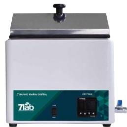
**Banho Maria:** São equipamentos que permitem a termorregulação de uma amostra, por meio do controle da temperatura de um fluido térmico, o qual é colocado dentro da cuba do banho e que irá transferir a temperatura ajustada no banho para a amostra imersa nele.
