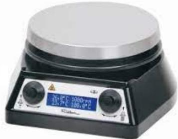
**Agitador Magnético:** É um equipamento de laboratório utilizado para realizar misturas de amostras diversas, mas sempre com baixa viscosidade. Ele emprega um campo magnético rotativo para fazer com que uma barra de agitação imersa em um líquido gire muito rapidamente, agitando-o.
