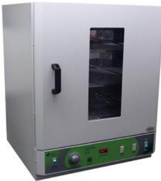
**Estufa:** de secagem para laboratório é conhecida como um aparelho elétrico utilizado para secagem de substancias sólida, evaporação lenta de líquido, armazenagem de substancias liquidas com temperaturas baixas, secagem de vidrarias.
