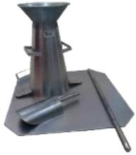
**Kit concreto:** Utilizados para moldagem de corpos de prova de concreto (10x20 cm).
