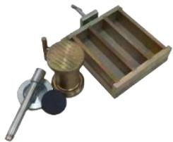
**Kit argamassa/concreto:** Equipamentos utilizados para moldagem de corpos de prova de argamassa, para realização de ensaios de flexão, compressão e absorção.
