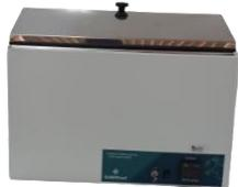
**Banho maria digital:** Utilizado para acondicionamento de corpos de prova de misturas asfálticas, permitindo ensaiá-los quanto à estabilidade e fluência.
