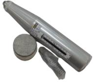
**Esclerômetro:** Serve para medir dureza superficial de rochas ou concreto.
