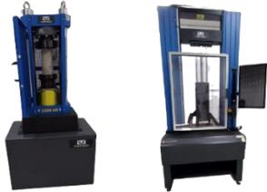
**Máquina universal de ensaios mecânicos com prensa hidráulica:** Utilizada para ensaios mecânicos em diferentes materiais utilizados na construção civil, tais como metais, polímeros, cerâmicas, concretos e argamassas.
