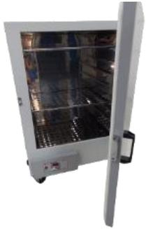
**Estufa:** Para acondicionamento de materiais e corpos de prova para realização de ensaios e análises.
