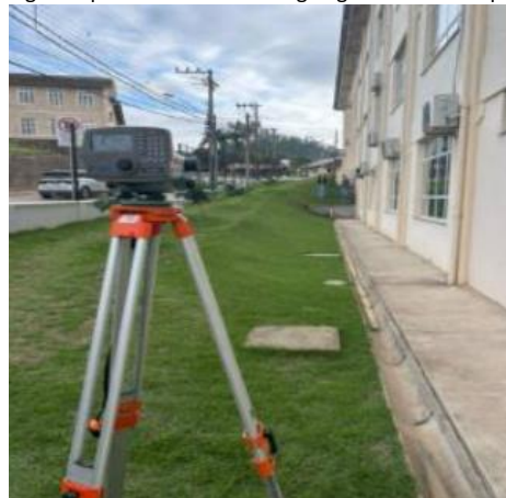
Figura – posicionamento de nível eletrônico
