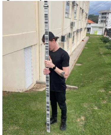
Figura – posicionamento da régua graduada sobre ponto de medição
