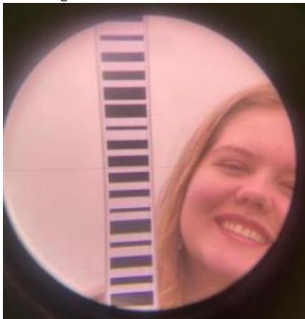
Figura – execução da medição com nível eletrônico
